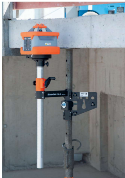
Fix-it an Baustütze befestigt
