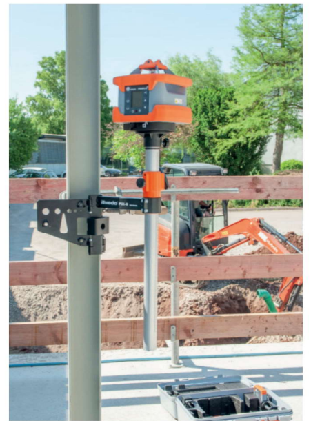
Befestigung mit Schraubzwinde an Stahlträger
