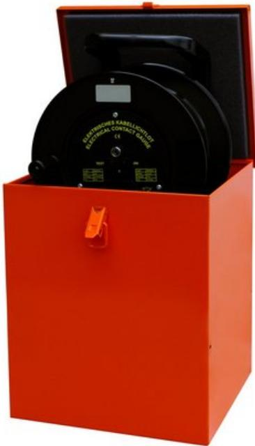
Kabellichtlot, elektrisch zum Messen von tiefliegenden Wasserständen. Optisches und akustisches Signal am Aufrollbock bei Berührung der Edelstahlsonde mit der Flüssigkeitsoberfläche in der Tiefe.
